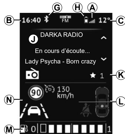
Radio avec affichage au tableau de bord
