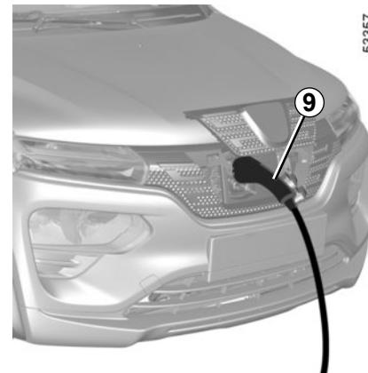
Die Warnblinkanlage blinkt fünfmal, um anzuzeigen, dass der Ladevorgang begonnen hat.
