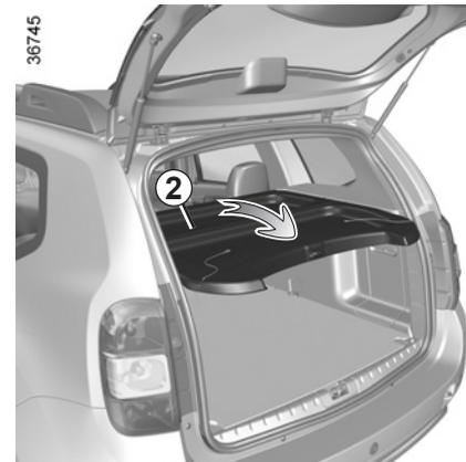
Die Ablage leicht anheben **2** und beidseitig haltend nach hinten herausziehen.
