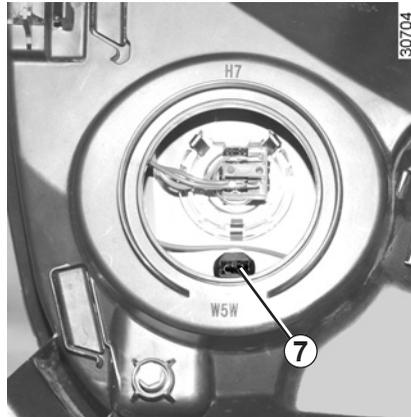
Entfernen Sie den Lampenträger **7**.
