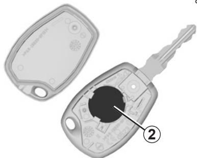
Die Batterie **2** austauschen; auf korrekte Polarität (im Gehäusedeckel eingepreßt) achten!
