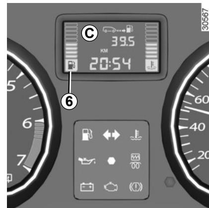
Im **4x4**-Einsatz (**4WD**) in zerklüftetem Gelände wird eventuell eine falsche Information zum Kraftstoffvorrat angezeigt. Warten Sie, bis Sie wieder auf ebener Strecke fahren und sich die Füllstands symbole stabilisiert haben, um einen korrekten Füllstand abzulesen.
