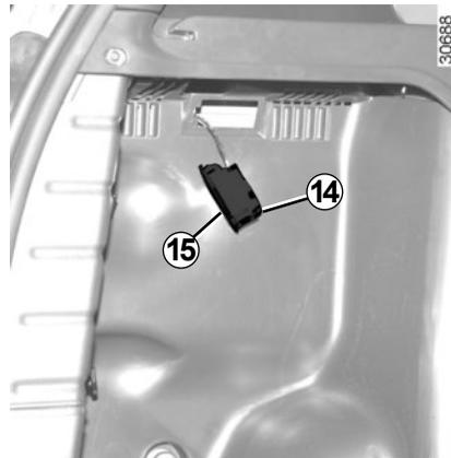
Drücken Sie auf die Federzunge **14**, um das Lampenglas **15** zu lösen.
