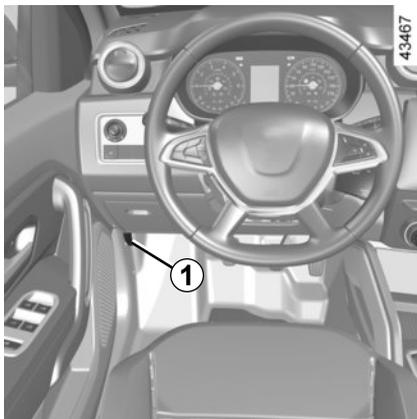
Zum Öffnen ziehen Sie den Griff **1** oder (je nach Fahrzeug) den Bedienhebel **2**.
